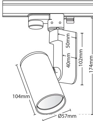
29142 DICHROIC 230V 50W GU 10 / LED LAMP 230V GU10 3W-4W-5W-6,5W \*
